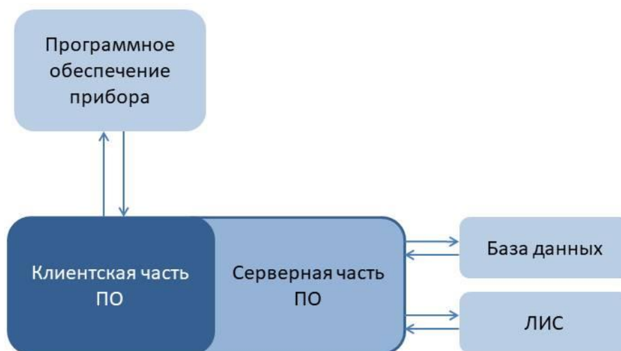
Рис.1 – Схема взаимодействия составных частей ПО
